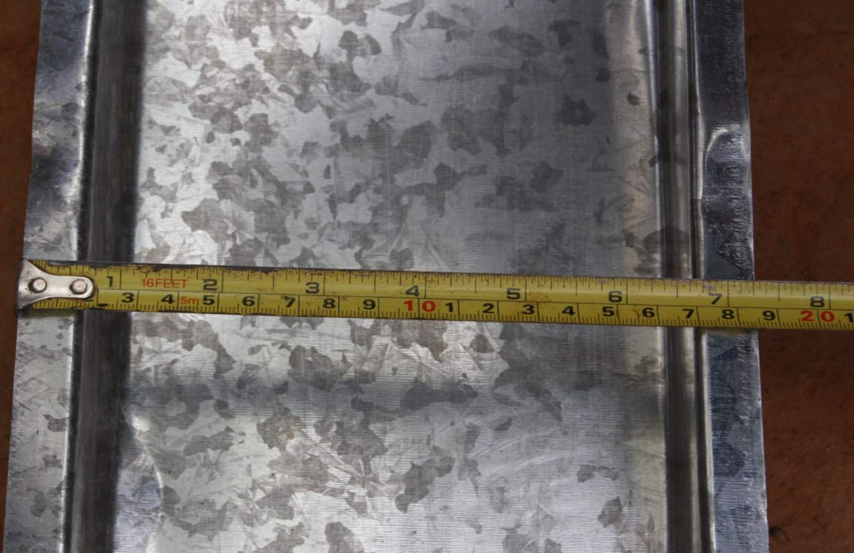
Medida da Calha na sua Parte Externa (09 cm)
