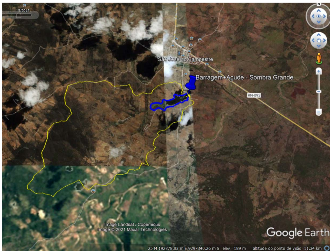
Figura 04: Google Earth (poligonal da bacia hidrográfica de contribuição para a barragem Sombra Grande, estimada com base em modelo digital de elevação gerado com dados da missão SRTM, com pixels de 30 m de resolução espacial. A metodologia envolveu tratamento dos dados brutos, via remoção de depressões espúrias, a definição dos modelos de direção de fluxo, de acumulação de fluxo e a delimitação dos pixels contribuintes para o ponto definido para o barramento
