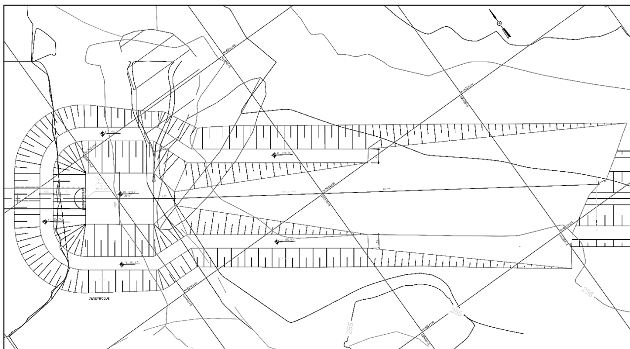
Figura 4.5: Detalhe da Geometria de Escavação do Desemboque do Túnel Vila Matias
