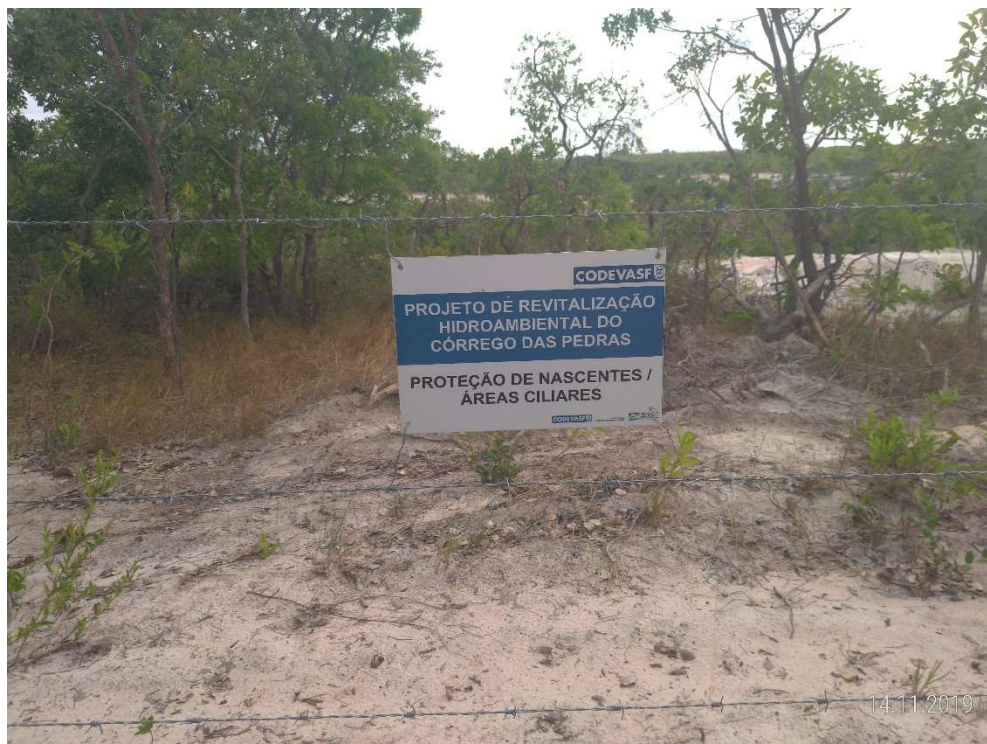
Figura 05. Placa 50 x 40 cm, aço galvanizado, a ser instalada na cerca, a cada 200 m.
